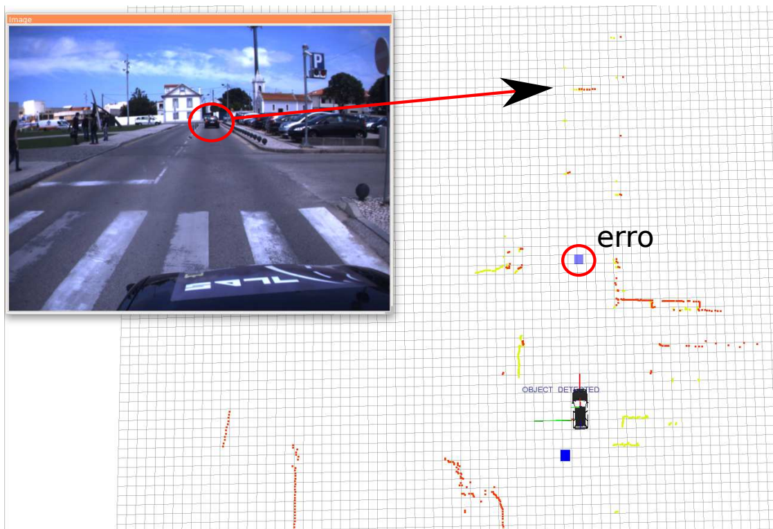
Figura 5.4: Erro na leitura de valores do laser, devido à inclinação do carro.
