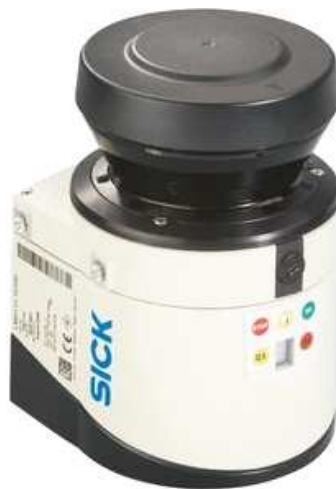
Figura 3.2: Sensor laser, instalado no AtlasCar.
