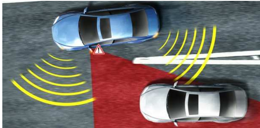
Figura 1.3: Sistema de auxílio ao condutor, quando outro veículo se encontra em ângulo "morto". (BOSH)
